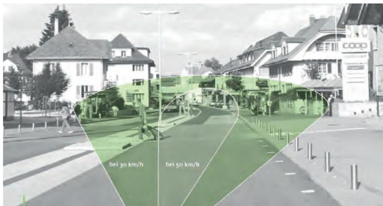
Systembild: Einschränkung des Sichtfeldes des Autofahrers bei einer Geschwindigkeit von 50 km/ h anstelle von 30 km/ h
